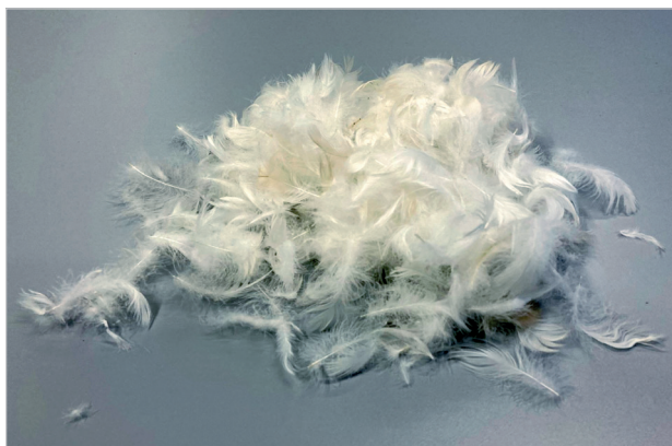
Fig. 1 - Feathers contain keratin, a structural protein insoluble in water that can be used to manufacture adhesives Le piume contengono cheratina, una proteina strutturale insolubile in acqua che può essere usata per produrre adesivi
